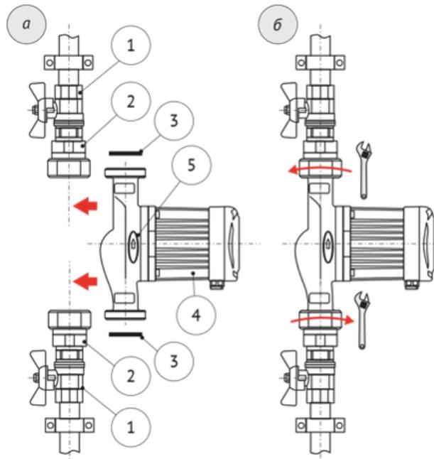
Соединение насоса 4 с трубопроводом производится с помощью входящих в комплект накидных гаек 2 и прокладок 3. При монтаже соблюдайте направление движения перекачиваемой среды, указанное стрелкой на корпусе проточной части насоса 5.
